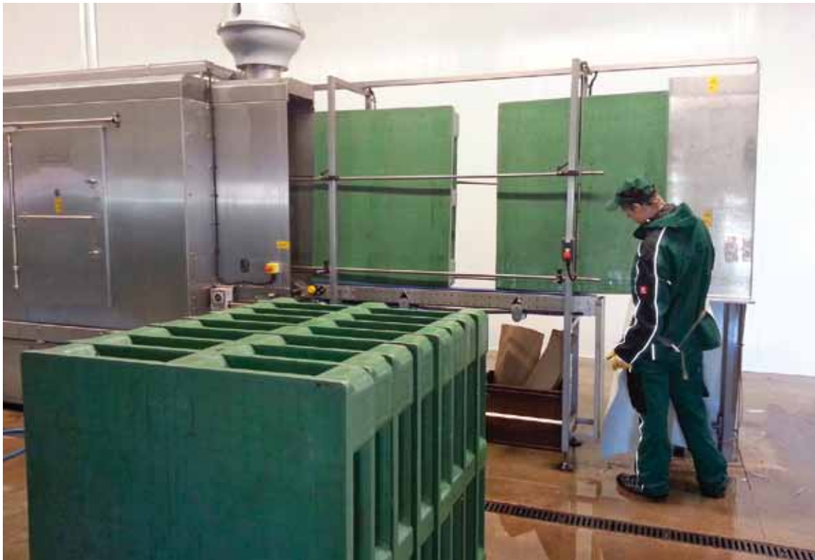
Die Kunststoffpaletten werden in der 20 m langen Reinigungsmaschine in drei Programmen gewaschen.
